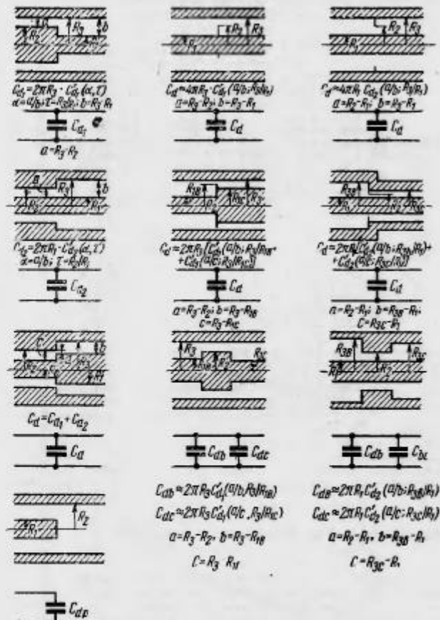
Рис. 3.2. Неоднородности в коаксиальных линиях передачи и их эквивалентные схемы
